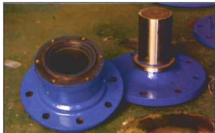
Alojamiento inferior con buje Vesconite insertado. Tramo del eje mostrado a la derecha.
